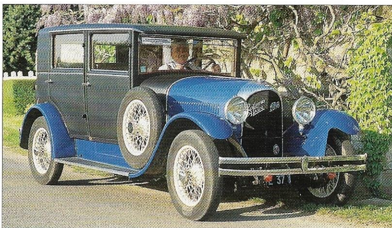
Un joyau qui fut épave... Superbe berline que cette Rolland Pilain de 1927 : 4,60 m de long pour quelque 1 500 kg, 4 vitesses plus la marche arrière, et pas même 10 litres au 100 pour cette 4-cylindres de 1 500 cm 3 , repeinte dans son bleu d'origine.
